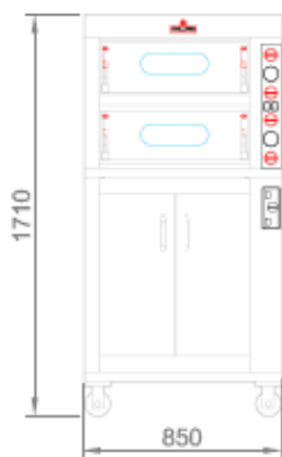
VISTA FRONTALE + CELLA DI LIEVITAZIONE FRONT VIEW + PROVER
